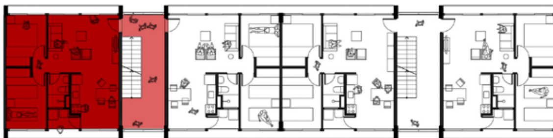
Figura 1.46: Planta do Complexo Jardim Edite, destacando-se em vermelho a unidade particular e a área comum acessível por ela
