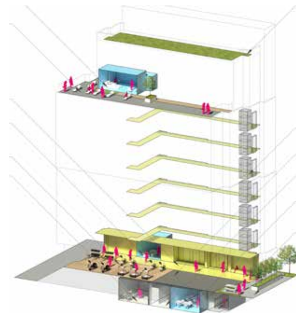
Figura 1.30: Perspectiva axonométrica do Carmel Place mostrando sua distribuição de usos.
