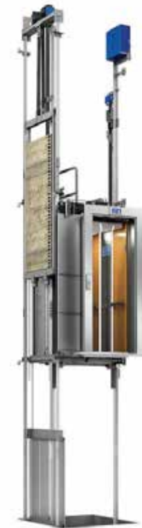
Figura 1.106 Elevador Gen 2 Confort da Otis. Elevador sem casa de máquina e com tecnologias regenerativa, proporcionando uma maior economia de energia. Além disso a sua iluminação é de LED que também garante uma maior economia. Sua velocidade é de 2m/s, atendendo às exigências da NBR para o porte do edifício.
